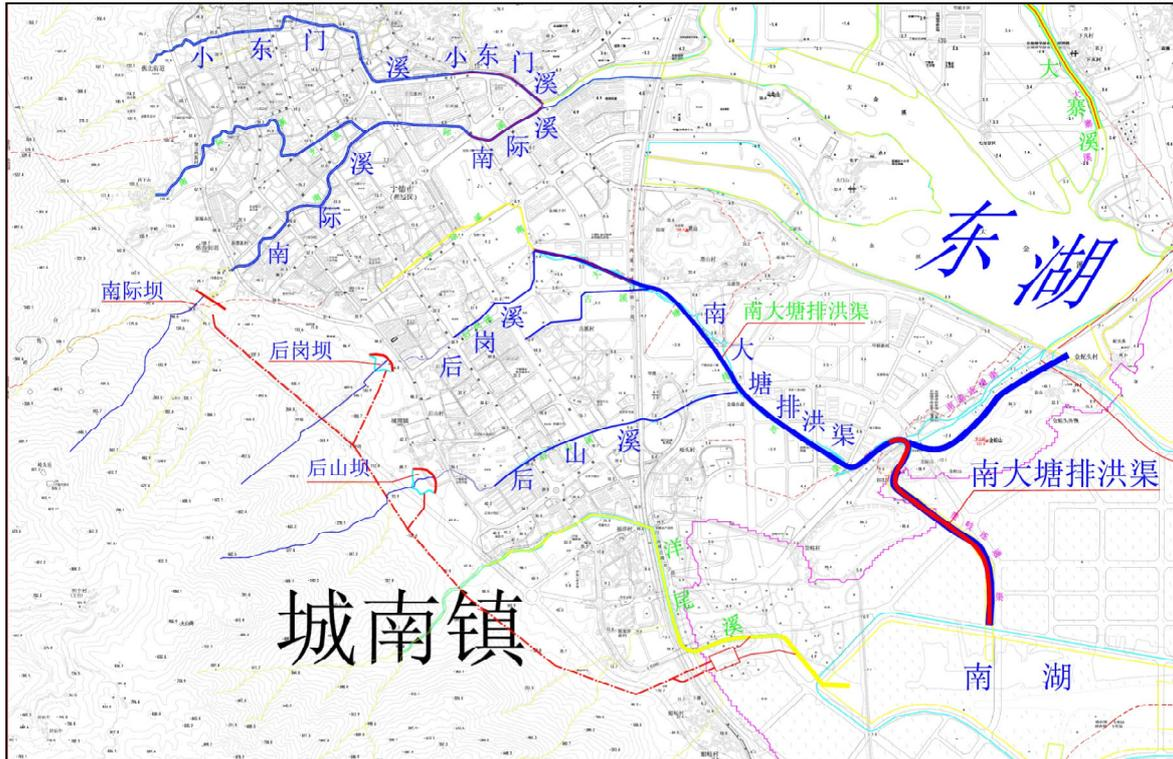
拟建的南际坝、后岗坝、后山坝。规划排洪洞总长 5.33km，开挖洞径约 4.5m，需下穿同三高速公路。匡算工程投资约 5.56 亿元。
