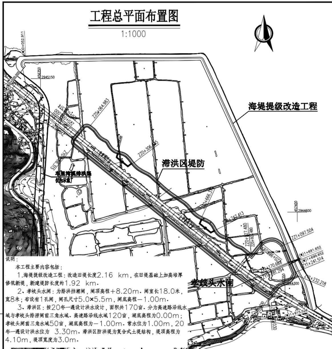
图 1-6-5 车里湾片区防洪排涝海堤及滞洪区平面布置图
