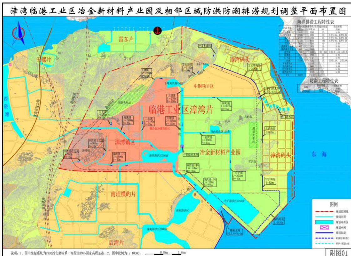
图 1-6-2 漳湾临港工业区防洪排涝规划平面布置图
